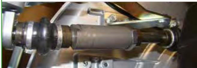
Boîtier de transmission hydrostatique entraîné par cardan.
